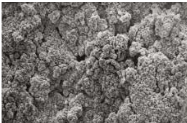
Plattenoberfläche einer neuen Batterie unter dem Elektronenmikroskop. Keine Kristalle, lediglich amorphes Bleisulfat.
